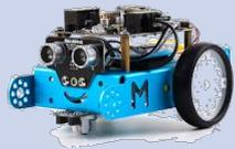
**Pb: un véhicule sans chauffeur se déplace en suivant des lignes, compte des intersections, détecte des obstacles , des zones sombres**
